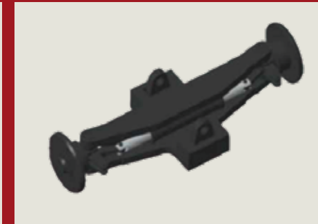
Tek çift etkili enine silindirli direksiyon aksı, tam hidrolik güç direksiyonu ve yük algılama direksiyon dişlisi kolay direksiyon hareketi sağlayabilir.
